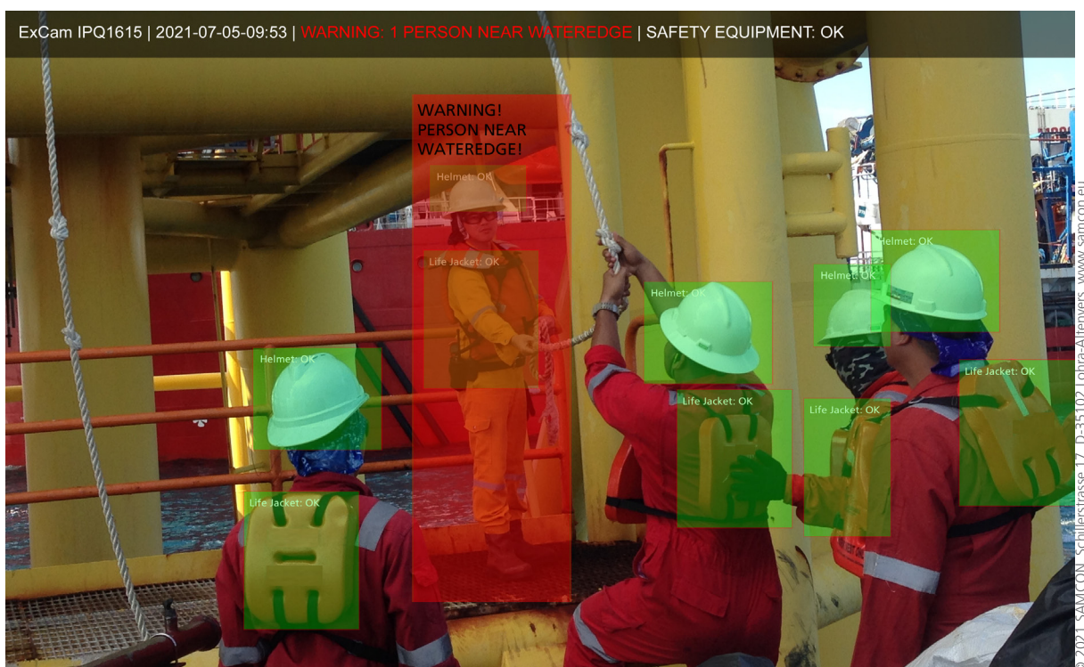
BILD 2: Beispiel einer algorithmischen Gefahrenerkennung mit KI Ansatz.
