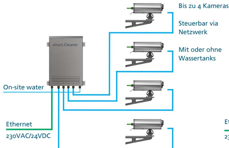
Setup mit integriertem 20l Druckbehälter
