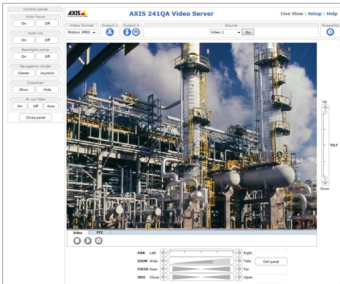
Abb.6.8 – Steuerung und Visualisierung über einen Videosever
