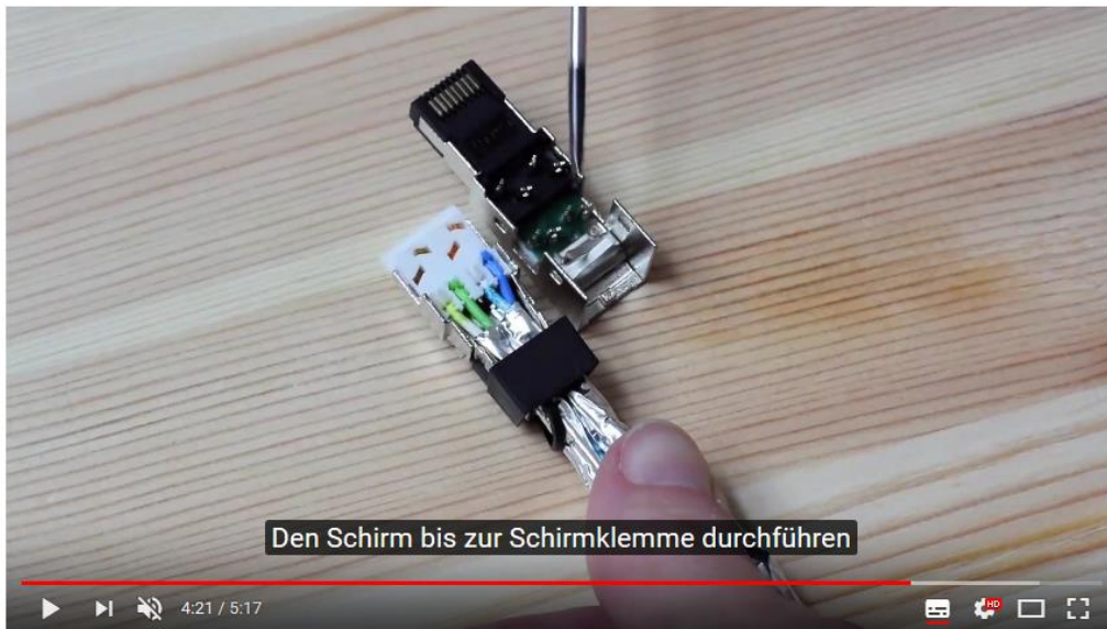
Bild 5-12 Stecker Belegung RJ45
