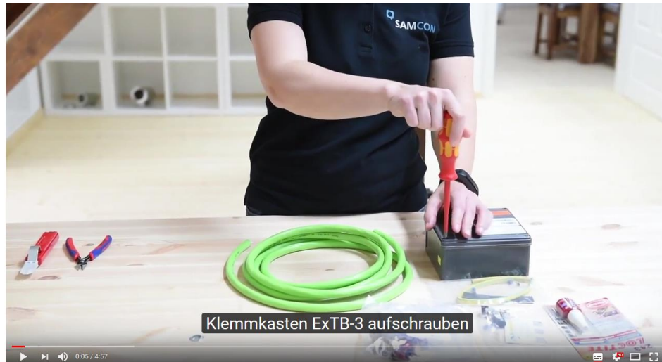
Илл. 5-4 Видео-учебник ExTB-3: отвинчивание клеммной коробки ExTB-3
