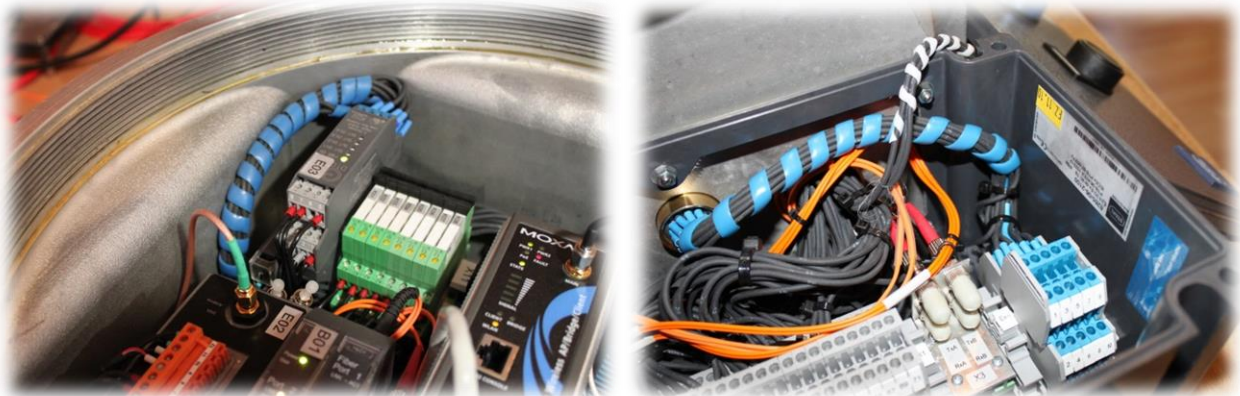
Рис.8.2: Искробезопасные электрические цепи устройства ExConnection Rail
